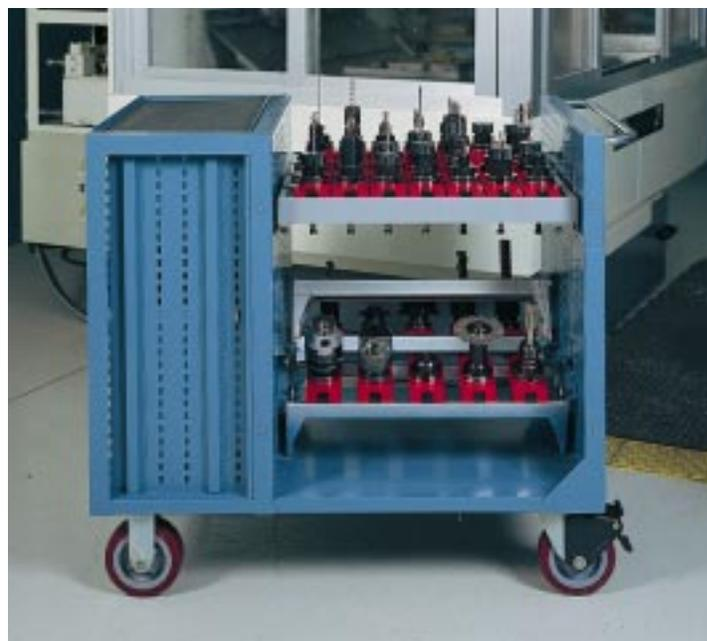
***En este taller de herramientas, una pared de almacenamiento Lista está equipada con armazones y bandejas para portaherramientas. Los cajones de extensión completa del sistema ofrecen un acceso completo a las herramientas NC, y las puertas de corredera proveen seguridad y apariencia pulcra.***
