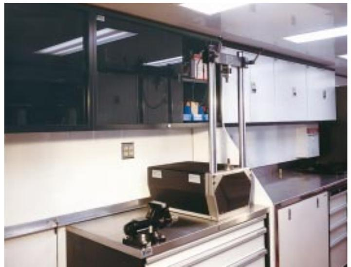
**Los armarios sobrepuestos con puertas embisagradas y puertas de correderas de plexiglas ahumado proveen un almacenamiento organizado, eficiente para este acoplado de carrera.**
