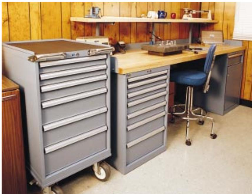
*Un banco de trabajo industrial Lista con repisa elevada ajustable, juntamente con un armario móvil de almacenamiento, ayuda a optimizar la producción en este laboratorio de control de calidad de un fabricante de centrifugas.*
