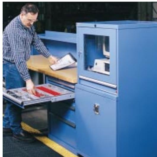
*En el piso de fabricación de Continental Machines, un armario de computadora Lista protege el equipo de computadora contra desechos potencialmente peligrosos.*
