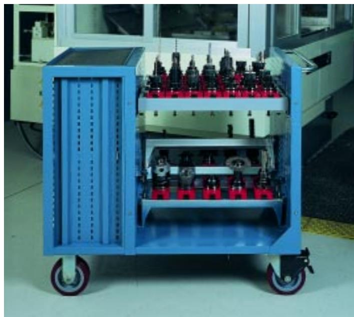
*Dans cet atelier d'usinage, une murale d'entreposage Lista est équipée de tablette coulissantes et cadres de support d'outil. Les tiroirs à extension totale du système assurent un accès complet aux outils à commande numérique et les portes coulissantes assurent sécurité et netteté d'aspect.*
