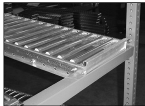
Parte posterior (lado de carga) de la pista deslizante tipo celda.
