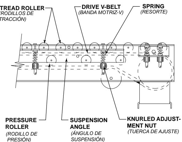
**¡PRECAUCIÓN!** Apretar la banda demasiado puede causar que el transportador se detenga.
