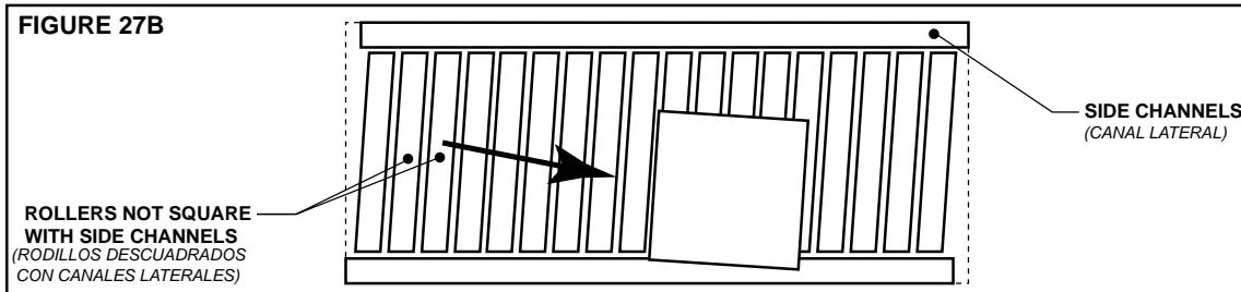
Secciones "descuadradas" del transportador hacen que el producto se mueva hacia un lado del transportador.
